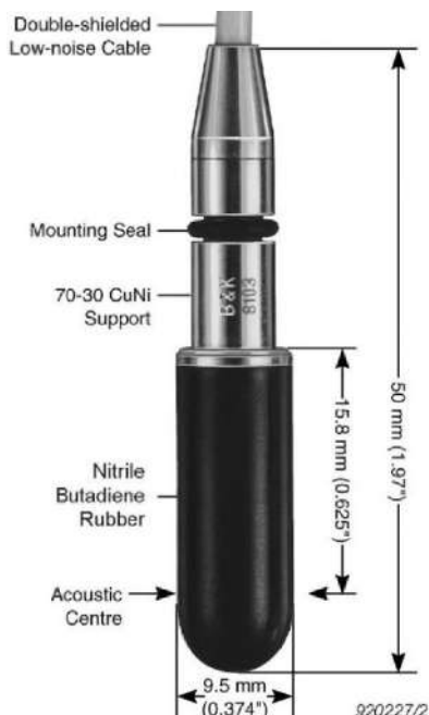
Fig. 14. Brüel & Kjær Hydrophone 8103 Dimensions
