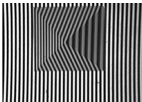
Fig. 5. Imagen con proyección de Luz estructurada
