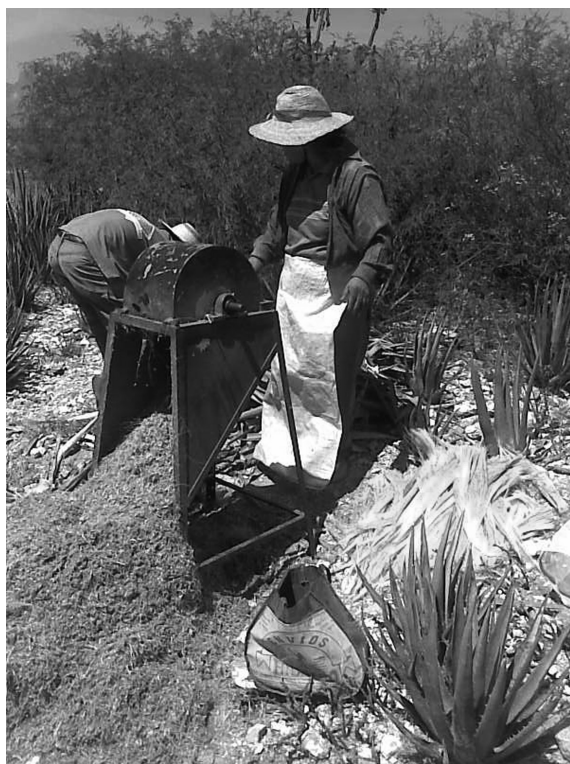
Foto 3 Proceso de obtención de ixtle y xithé con máquina de gasolina. Valle del Mezquital, Hidalgo, 2008
