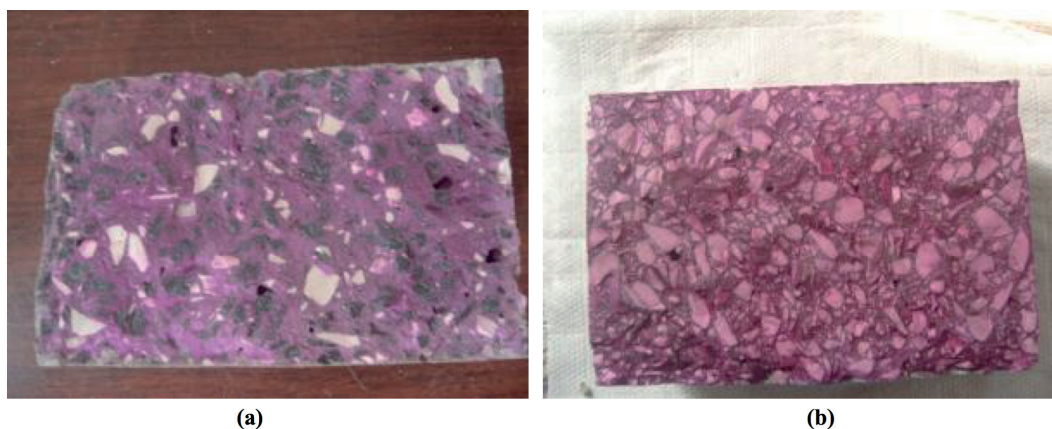
Fig. 14: Carbonatação aos 365 traço C 25.25 (a), C 100.100 (b).
