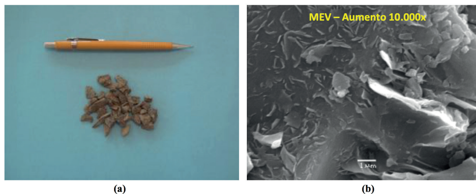
Fig. 3: Agregado graúdo comum brita (a) e MEV brita (b).
