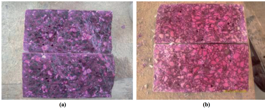
Fig. 13: Carbonatação traço C 25.25 (a) e traço C 100.100 (b) aos 28 dias de idade.
