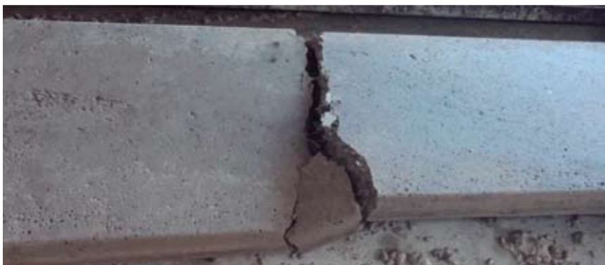
Fig. 21: Ruptura da placa sem armadura durante o armazenamento.
