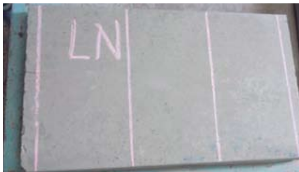
Fig. 22: Acabamento superficial de placa não armada produzida no método 2.
