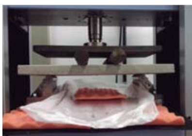
Fig. 8: Equipamento utilizado no ensaio de flexão.
