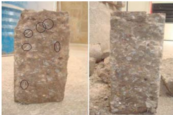
Fig. 24: Orientação das fibras nos corpos de prova dos métodos 1 e 2, respectivamente.
