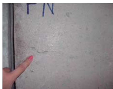
Fig. 15: Fissuração na região central da placa sem armação.
