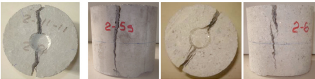
Probeta moldeada de 100 mm (M2-5) y probeta testigo de 93 mm (M2-6).
