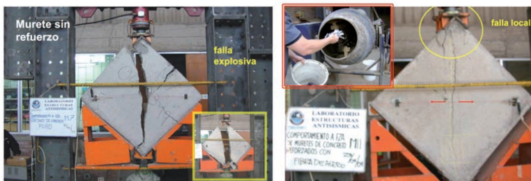
Fig. 2: Murete sin refuerzo (izquierda) y reforzado con fibra metálica (derecha). San Bartolomé et al. , (2007).
