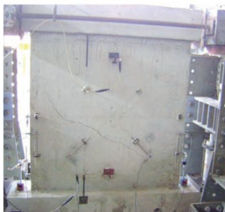
Fig. 7: Instrumentación usada en los 3 muros.
