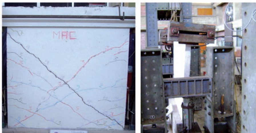
Fig. 9: Fase 7 en el muro MAC. Falla final por alabeo.
