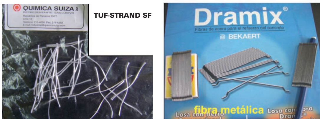
Fig.5: Fibra de polipropileno (izquierda) y fibra de acero (derecha).
