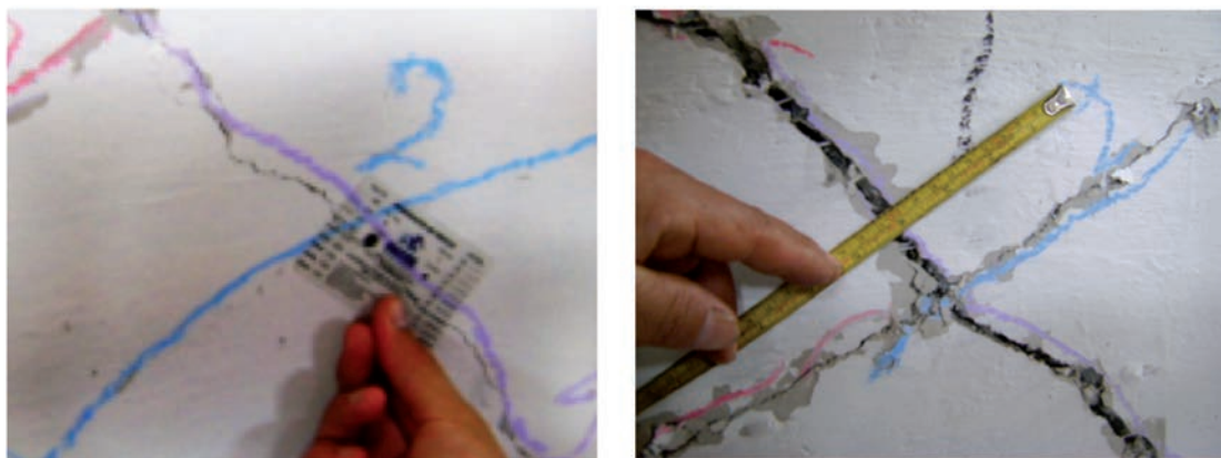
Fig. 14: Medición del grosor máximo de grieta ( G ) con el comparador y con cinta métrica.
