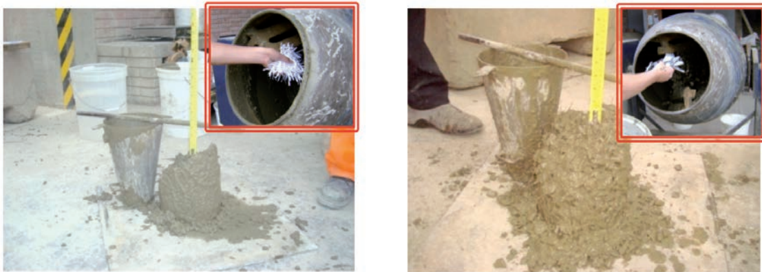
Fig. 4: Revenimiento del concreto con fibra de polipropileno (izquierda) y con fibra de acero (derecha).
