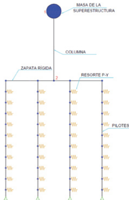
Fig. 10: Modelo estructural en OpenSees.
