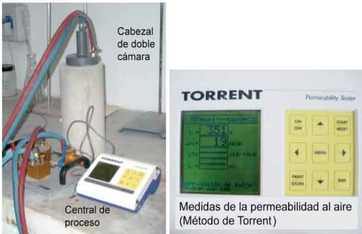
Fig. 4. Equipo de Torrent para la determinación de la permeabilidad al aire del concreto de recubrimiento.
