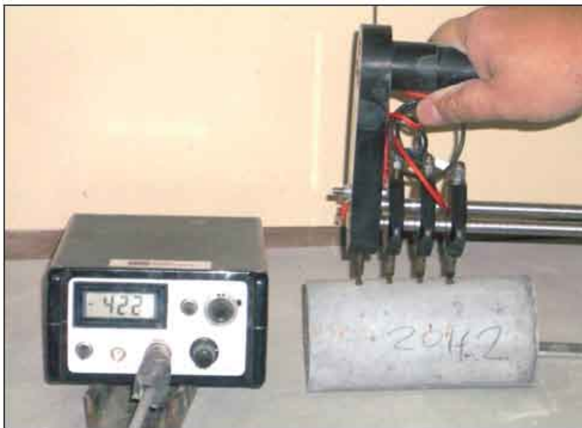
Fig. 6. Medición de la resistividad eléctrica del concreto empleando el método de los electrodos puntuales equidistantes a 20 mm.
