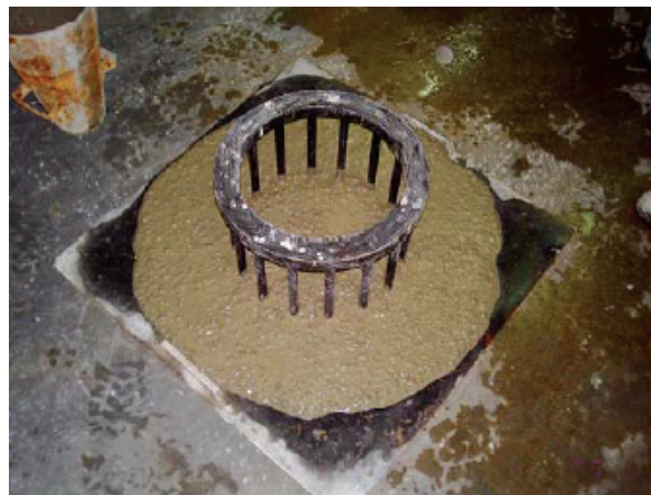
Foto. 3 Extendido con J-Ring (360-A).
