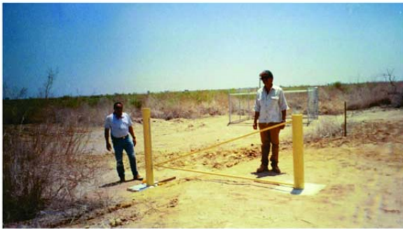
Figura 3. Fotografía y diagrama de instalación de los instrumentos geotécnicos: extensómetro vertical (EV) y testigo 3D (T-3D).
