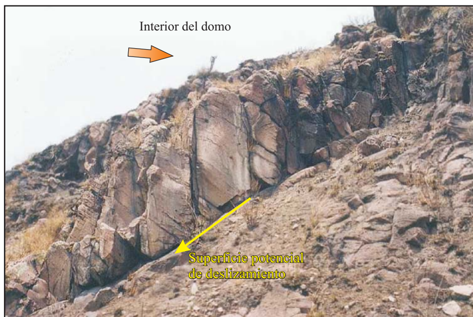
Figura 15. Bloques tabulares apoyados sobre un plano inclinado, donde se puede presentar el volteo y/o deslizamiento.
