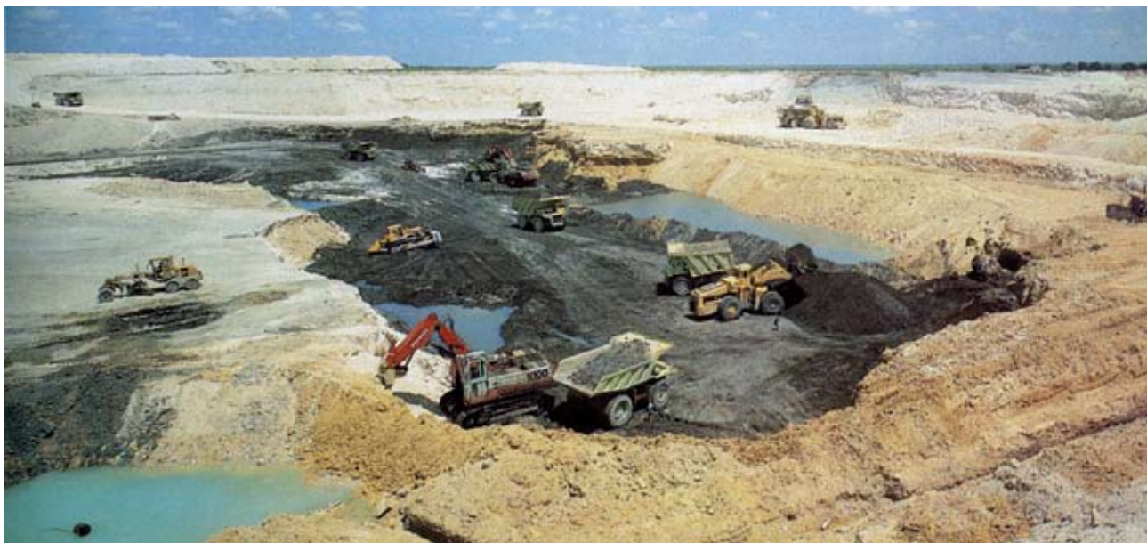
Figura 8. Vista panorámica del tajo de carbón en Piedras Negras, Coah. Incluido en la sub-región de Fuentes-Río Escondido. Abajo el color negro corresponde a la cima de la capa principal, la cual está dentro de la Formación Olmos del Cretácico. (Foto de Micare, 1982).
