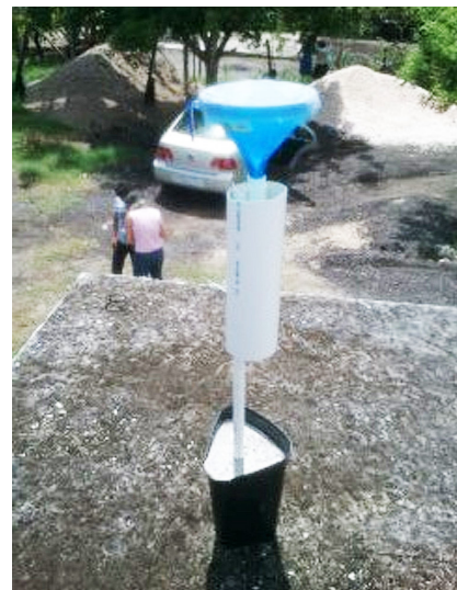
Figura 2. Dispositivo de muestreo utilizado para la recolección pasiva de N y S. Figure 2. Sampling device used for N and S passive collection.
