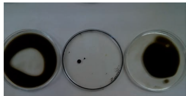
Figura 4. Desplazamiento del aceite quemado de motor en agua en presencia del biosurfactante (BS), extraído de los licores de lavado de maíz, y dodecil sulfato sódico (SDS), respecto a un control con agua.
