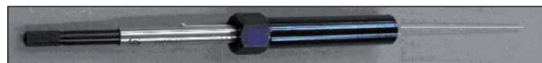
Figura 2. Sistema de micro extracción en fase sólida (MEFS). Figure 2. System of solid phase micro-extraction (MEFS).
