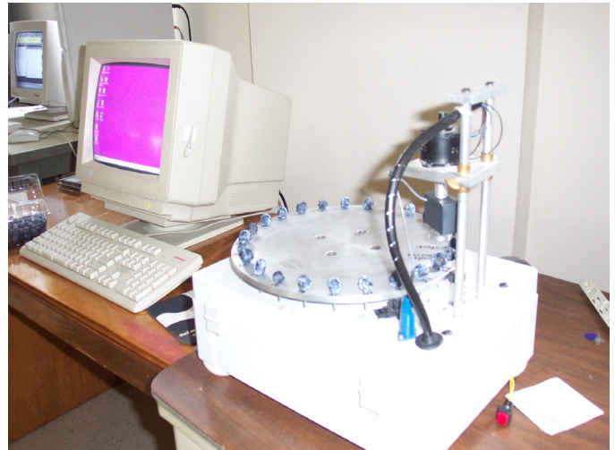
Figura 1. Instrumento Firm Tech II utilizado para medir la firmeza de frutos de Arándanos en esta investigación, Georgia EE.UU, 2003.
