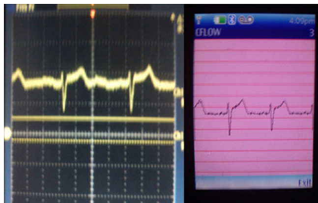
Figura 2 En el lado izquierdo de la figura se observa la señal del ECG en un osciloscopio colocando los electrodos en DI, de lado derecho se observa la misma señal pero ahora en la pantalla del móvil.
