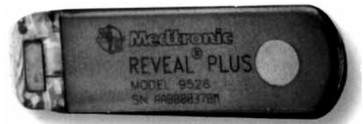
Figura 2. Grabadora de eventos en asa para el registro de arritmias poco frecuentes o de corta duración.
