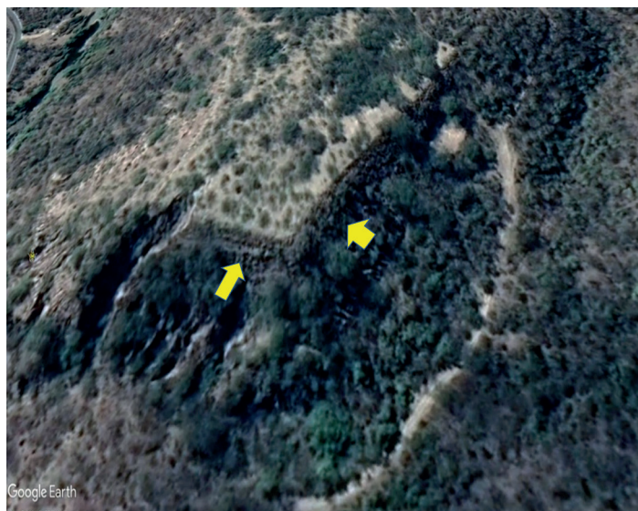
Figura 2: Depósito de jales “Las Presas” en Huautla, Morelos, retenido por presas de jales elaboradas con los mismos materiales. Las flechas señalan montículos de materiales dispersos formados por el daño de la erosión hídrica a la antigua presa de jal. Imagen: Google Earth, 2021.
